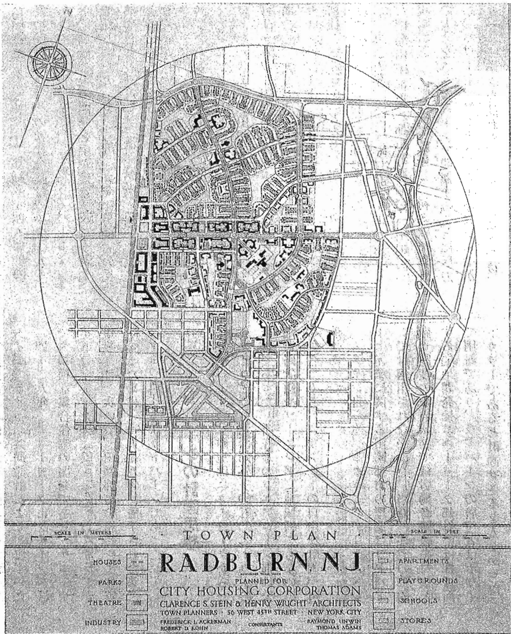
図1 ラドバーンの全体計画図 全体計画のうち西北部への2つのスーパーブロックのみが完成した。 【出典：参考文献3】
